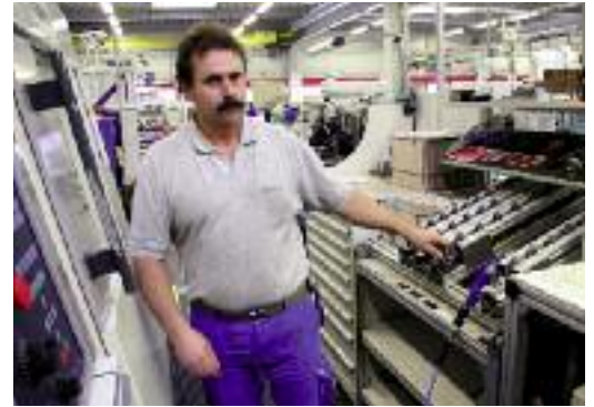
Um die Effizienz von WZMs zu steigern, empfiehlt es sich, etwa das Be-/Entladen zu erleichtern – hier an einer Traub-NC-Drehmaschine mit Kanban-Boxen und Zuführschielen für vorgeformte Rohteile.
