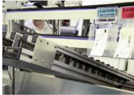
Um die Effizienz von WZMs zu steigern, empfiehlt es sich, etwa das Be-/Entladen zu erleichtern – hier an einer Traub-NC-Drehmaschine mit Kanban-Boxen und Zuführschielen für vorgeformte Rohteile.
